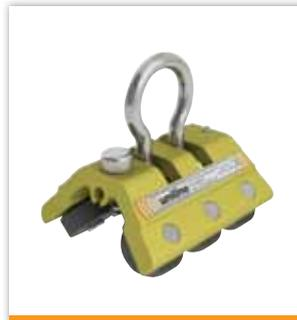
**Carro WT UniRail** (Código de pieza: 7241027) – el carro forma parte del sistema UniRail. Proporciona un punto de sujeción móvil para que los usuarios se conecten. Un usuario por carro. A utilizar sólo en sistemas rectos. Resistencia mínima 22 kN (5.000 lbs)
