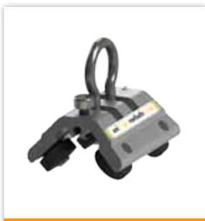
**Carro de acoplamiento** (Código de pieza: 7241006) – permite al usuario conectarse al sistema y disfrutar de un movimiento totalmente sin manos a lo largo del rail. Presenta un bloqueo de aparcamiento de acero inoxidable para tareas de posicionamiento de trabajo y ruedas de aluminio anodizado duro. Un grillete de acero inoxidable permite la conexión de un gancho de mosquetón y de pivotes para permitir la mejor funcionalidad con cualquier ángulo de toma. Resistencia mín. 15 KN (3300 lbs)
